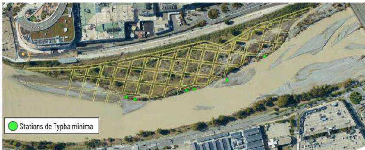
Figure 5 - Plan d'implantation des chenaux de dégraissage
