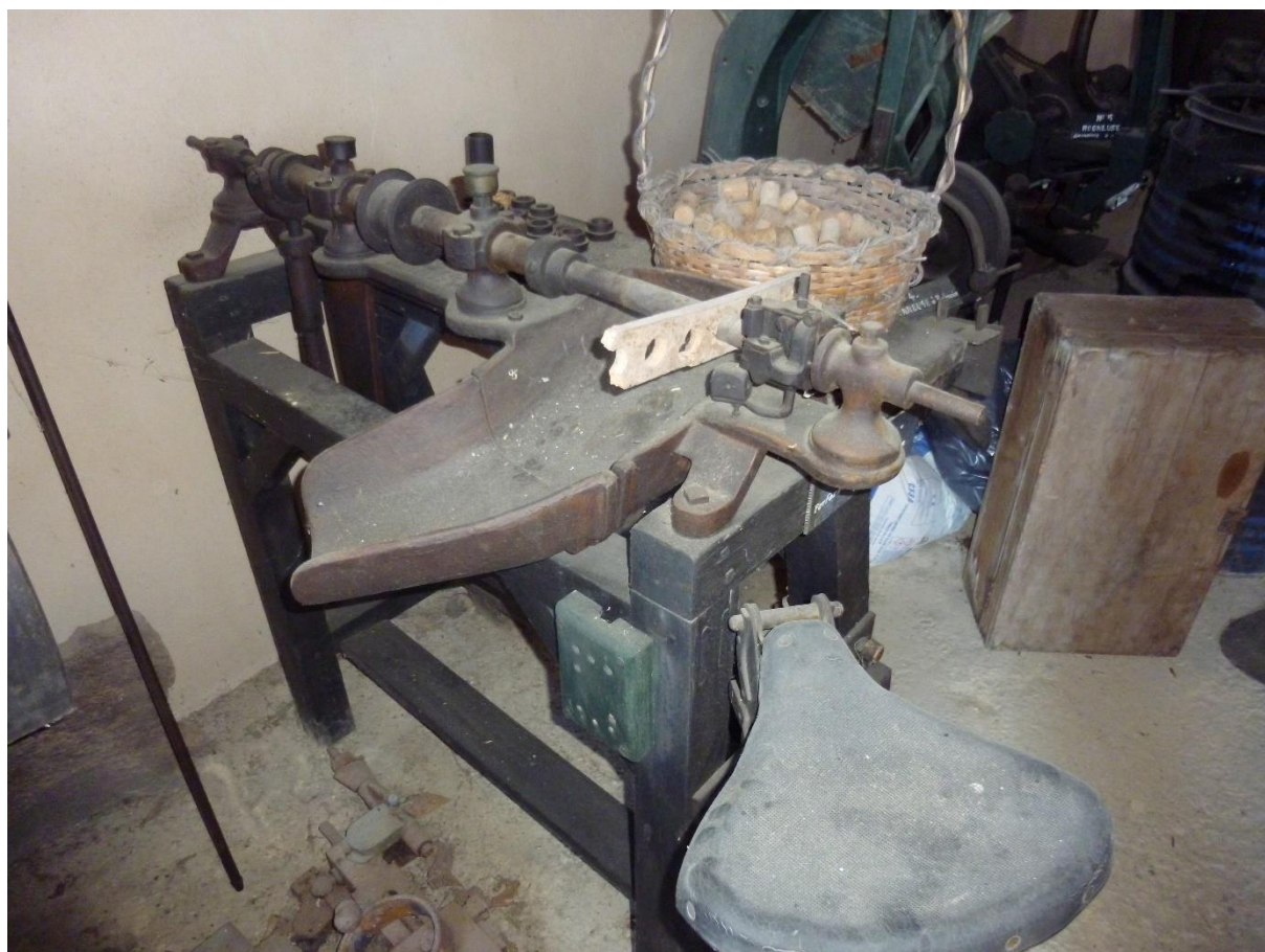
Fig. 11. Tourneuse, machine vouée à la formation des bouchons cylindriques 220 .
