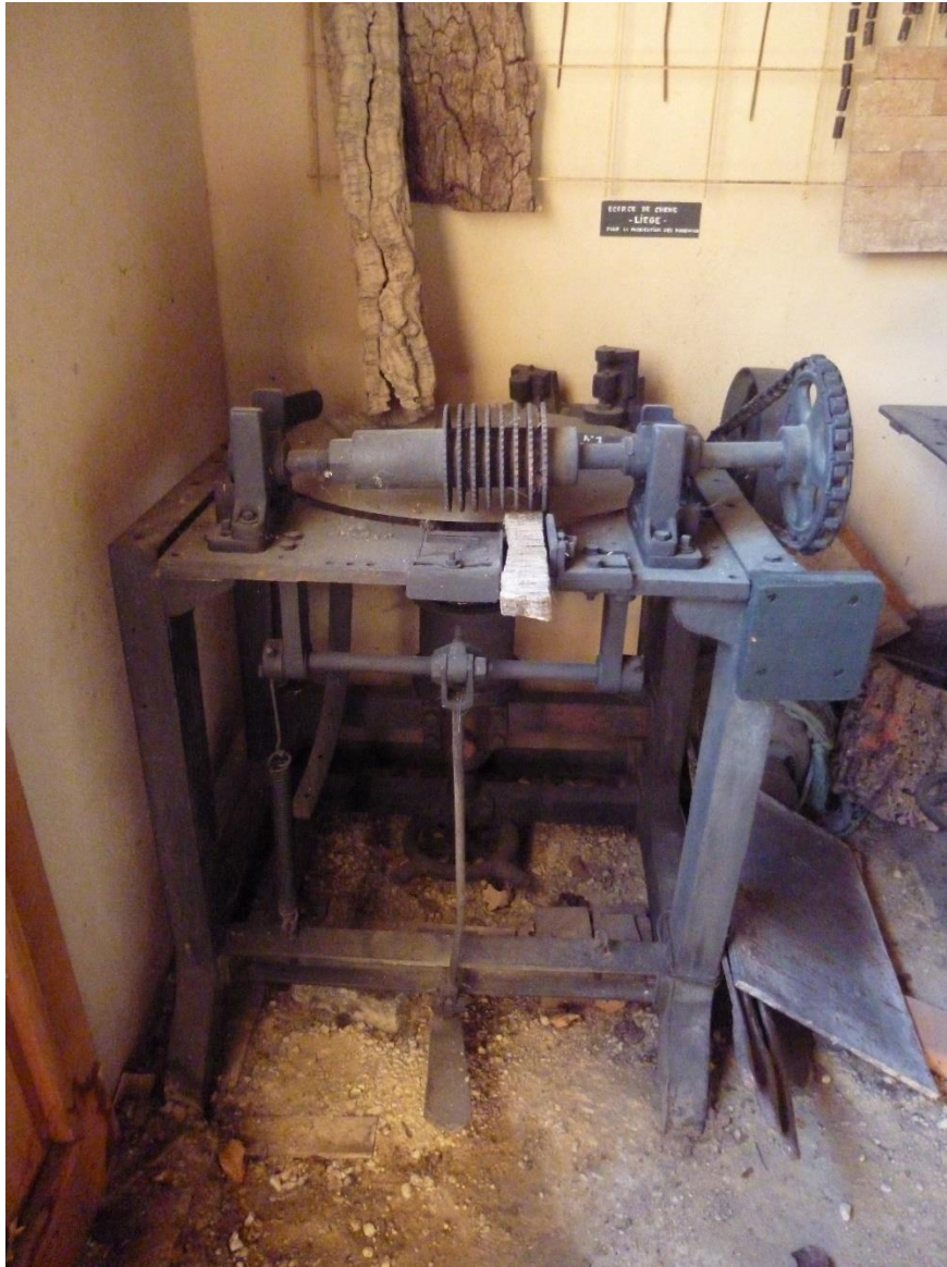
Fig. 10. Machine utilisée pour couper le liège en bandes 219 .
