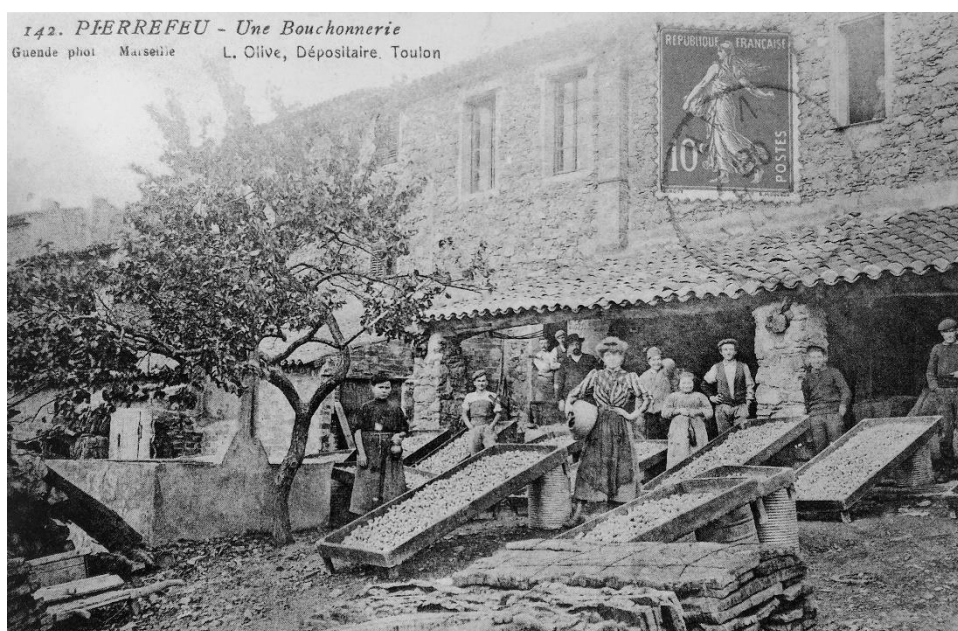
Fig. 5. Atelier de séchage des bouchons de liège, après lavage, dans une usine de Pierrefeu, carte postale de 1906 (Guende photographie Marseille. L.Olive, Dépositaire Toulon). Raymond Bernardi, Les métiers d'autrefois... op. cit., p. 133.
