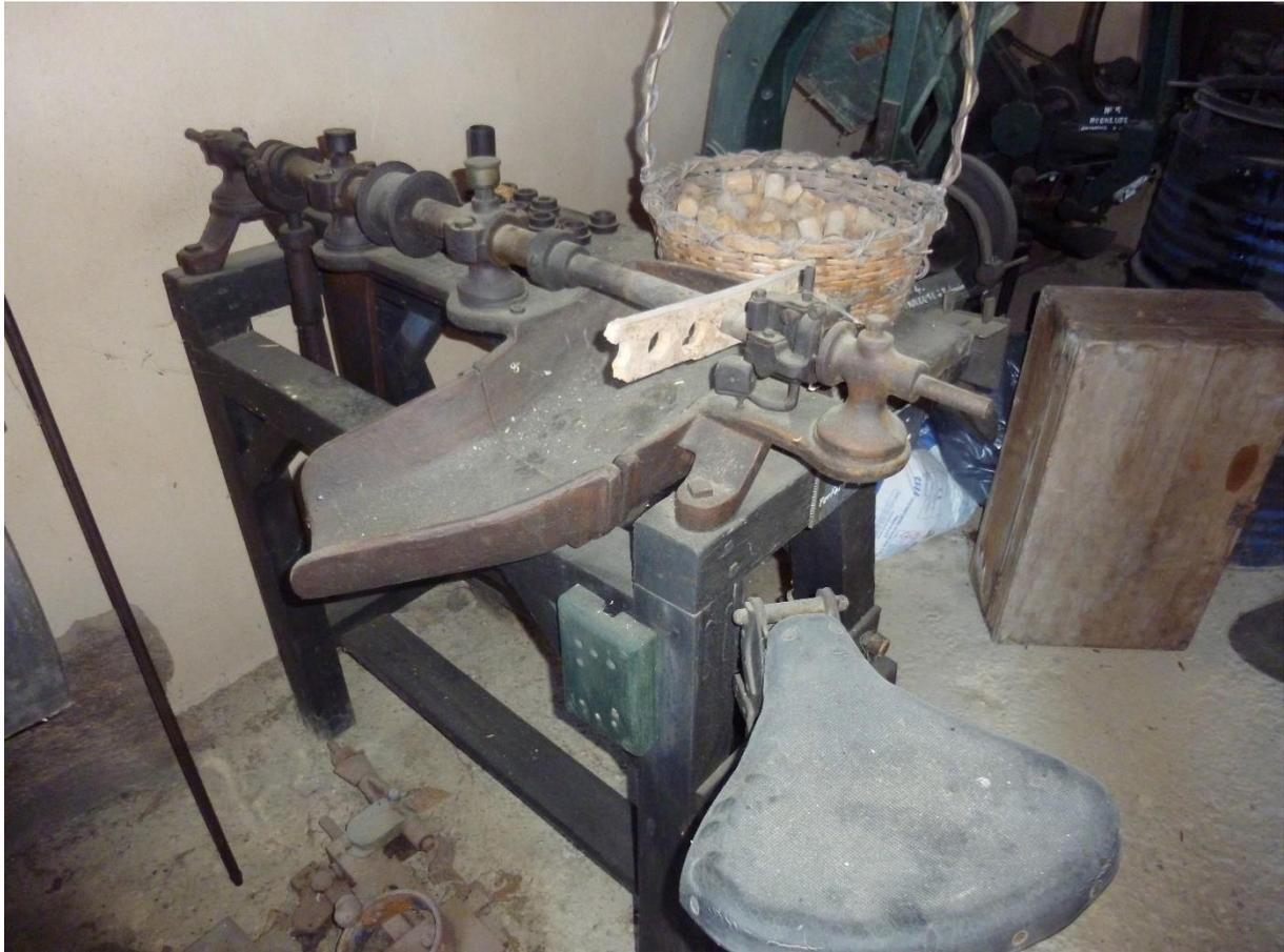
Fig. 11. Tourneuse, machine vouée à la formation des bouchons cylindriques<sup>220</sup>.
