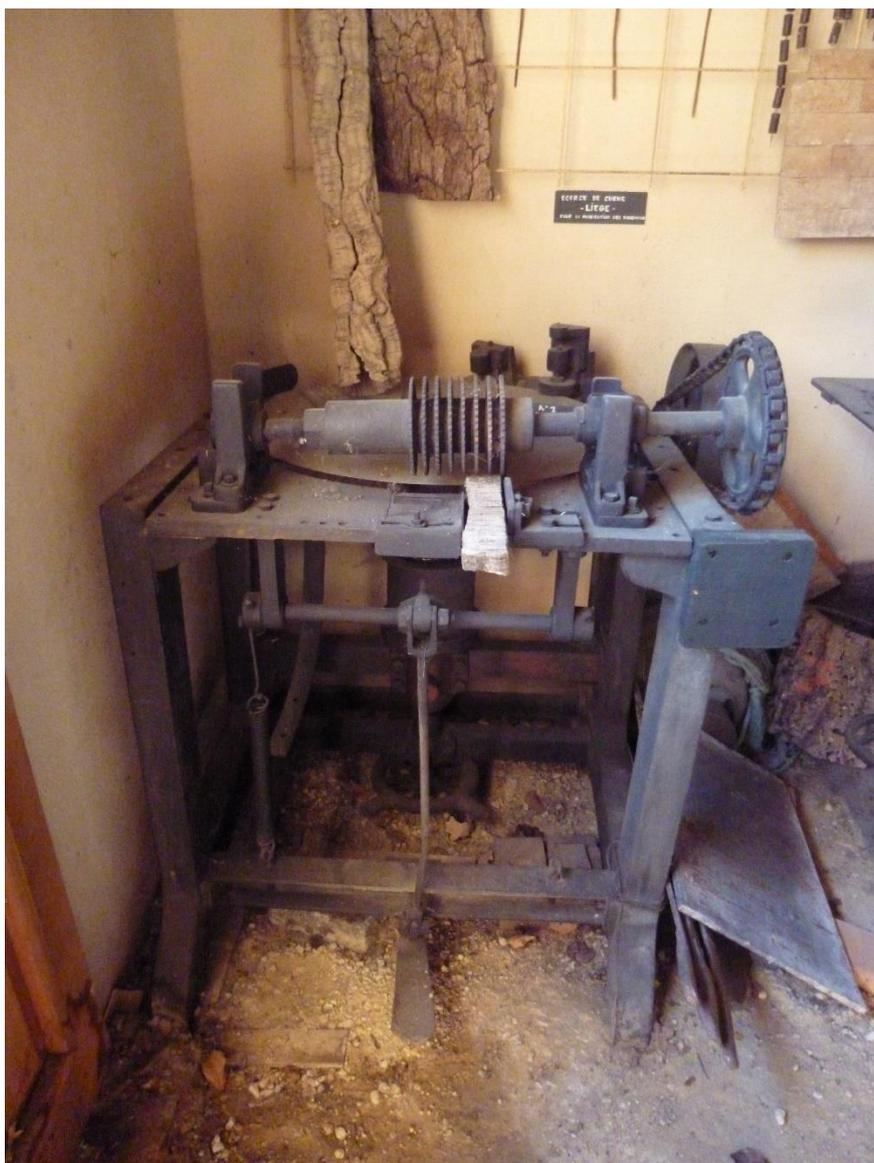
Fig. 10. Machine utilisée pour couper le liège en bandes<sup>219</sup>.
