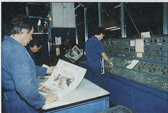
Le poste de commande et de réglage des « rotos ».
