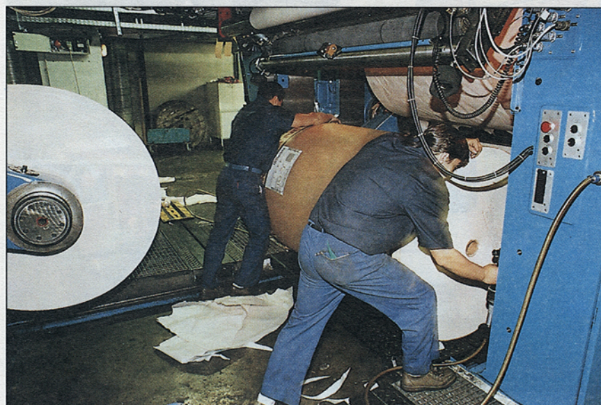
Le chargement des bobines.
