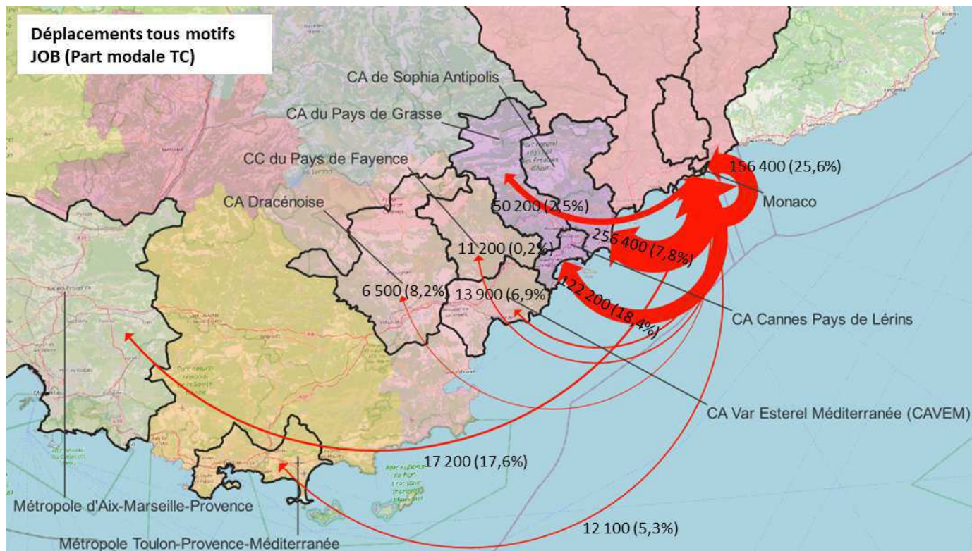
Figure 13 : Déplacements d'échanges avec des EPCI extérieurs au secteur tous motifs Jour Ouvré de Base (Part modale TC) (source : Systra - Étude des flux de déplacements)
